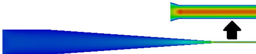
Figura 59 – Norma do campo de velocidade do modelo de Wang-Stoltz para  $H_d = 45\%$ .
