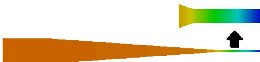
Figura 66 – Distribuição da pressão do Modelo Proposto para  $H_d = 45\%$ .
