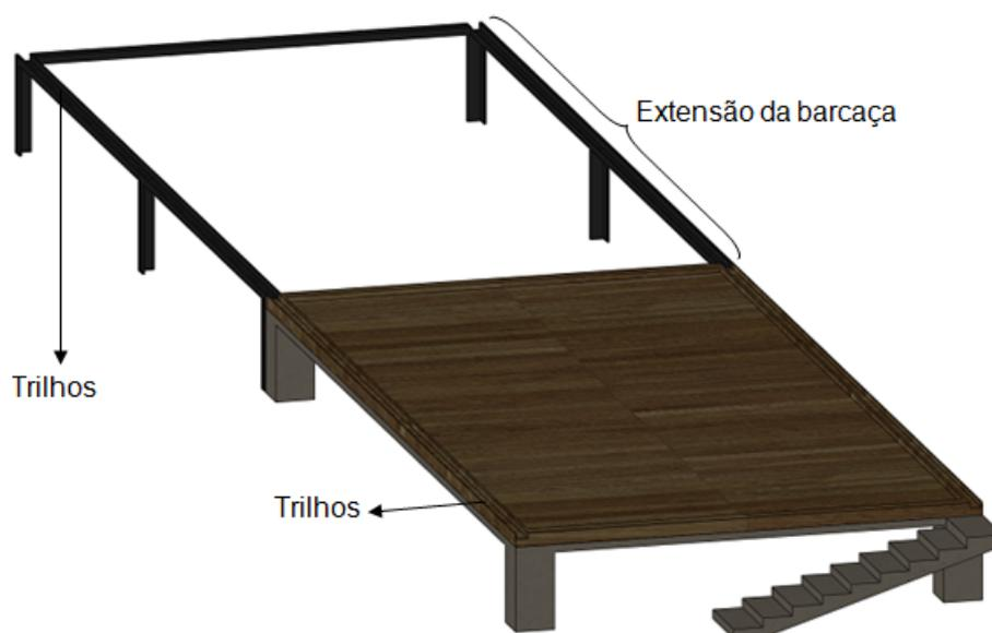
Figura 5 – Componentes da barçaça que proporcionam o deslocamento da cobertura de zinco.
